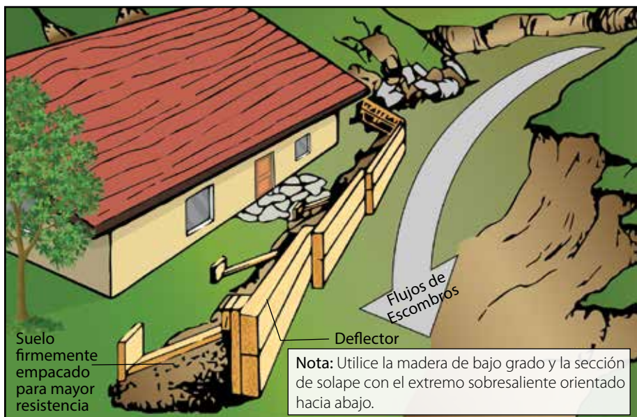
Fig. 18 - Deflector de Madera
