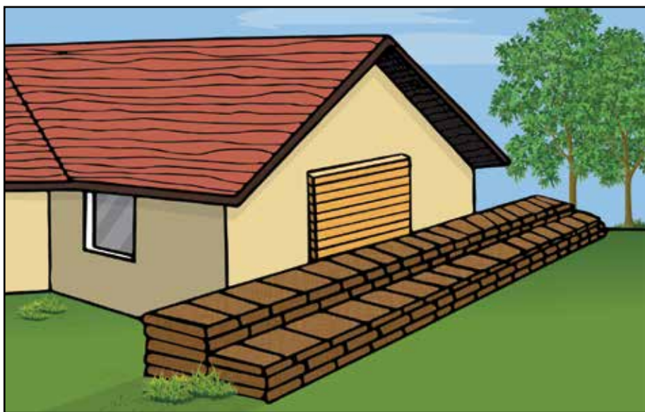
Fig. 5 - Apilamiento de Bolsas de Arena Contra los Edificios
