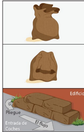
Fig. 4 LLENADO Y COLOCACION DE SACOS DE ARENA
