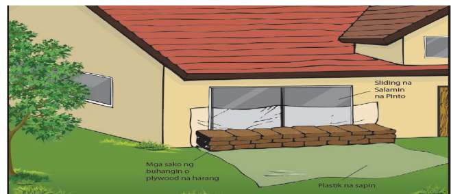
Larawan 11 PAGLALAGAY NG HARANG SA SLIDING GLASS DOOR Pagkontrol sa mga pag-ayos upang maiwasan ang pagpasok ng tubig sa mga sliding glass door.
